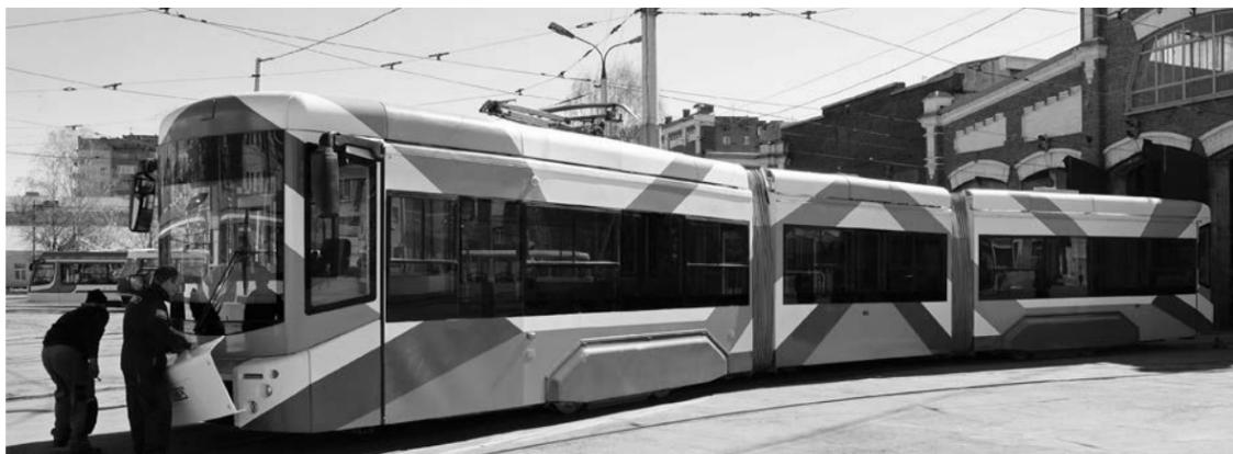
приводом на каждое колесо. Максимальная скорость, заявленная производителем, - 75 км/ч.
