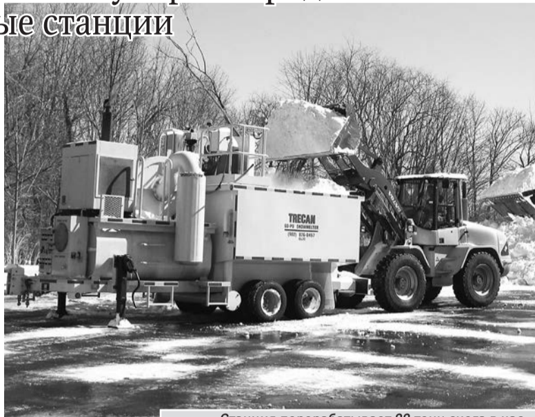
Станция перерабатывает 80 тонн снега в час
