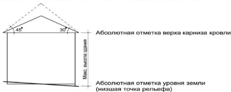
Рисунок А3 Здание со скатной кровлей, с углом наклона кровли более 30° (45° для индивидуальной жилой, блокированной застройки и дачных строений)
