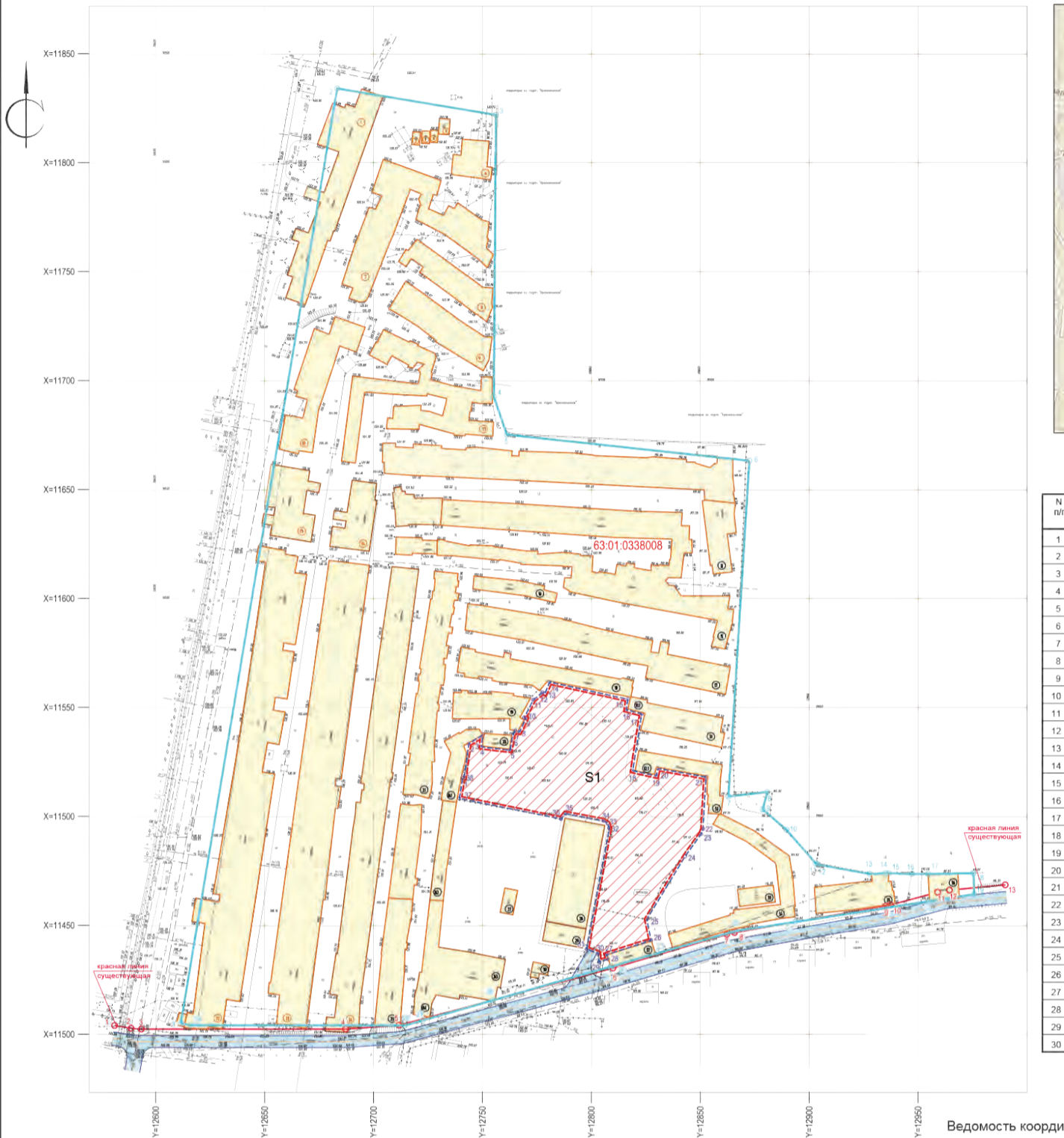
Проект планировки территории в границах зоны предприятий и складов V-IV классов вредности (санитарно-защитные зоны - до 100м) (ПК-1), прилегающей к кварталу 10 поселка Мехзавод в Красноглинском районе городского округа Самара. М 1:1000
